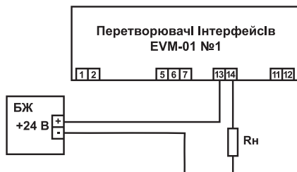
Малюнок Б.2 – Схема підключення до мережі сигналізації перетворювачів EVM-01, де Rn – опір навантаження
